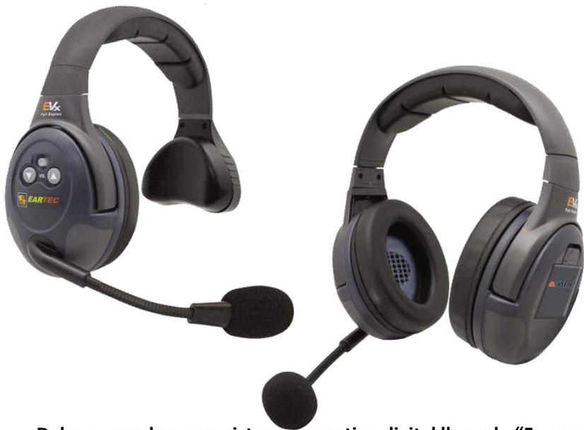
EVADE es una nueva generación de intercomunicadores full dúplex diseñados para equipos profesionales que requieren una comunicación manos libres nítida. Un sistema EVADE completo permite que hasta nueve usuarios hablen simultáneamente dentro de un rango de 300 Metros.
